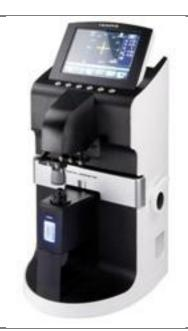
**HLM-7000** Автоматически распознает прогрессивные мультифокальные линзы и запускает процесс измерения, управляемый оператором при помощи пиктограмм на экране. Особенно интересное свойство прибора — автоматический поиск оптических центров для дали и близи на мультифокальных прогрессивных линзах, что позволяет даже неопытному оператору проводить высокоточные измерения.
