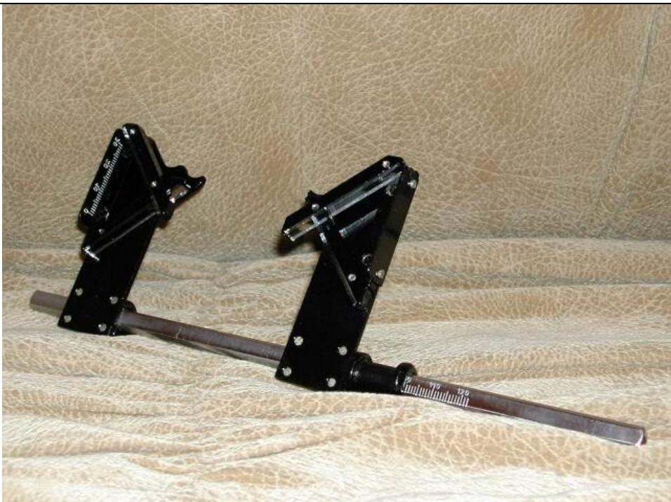
**Экзофтальмометр - это инструмент для определения степени выстояния глазного яблока. Позволяет производить точную диагностику экзофтальма.**
