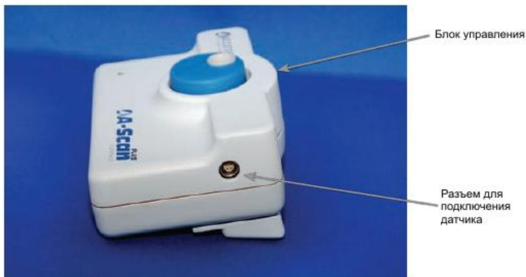
Рисунок 3-1 Блок управления и разъем для подключения датчика (правая сторона прибора)
