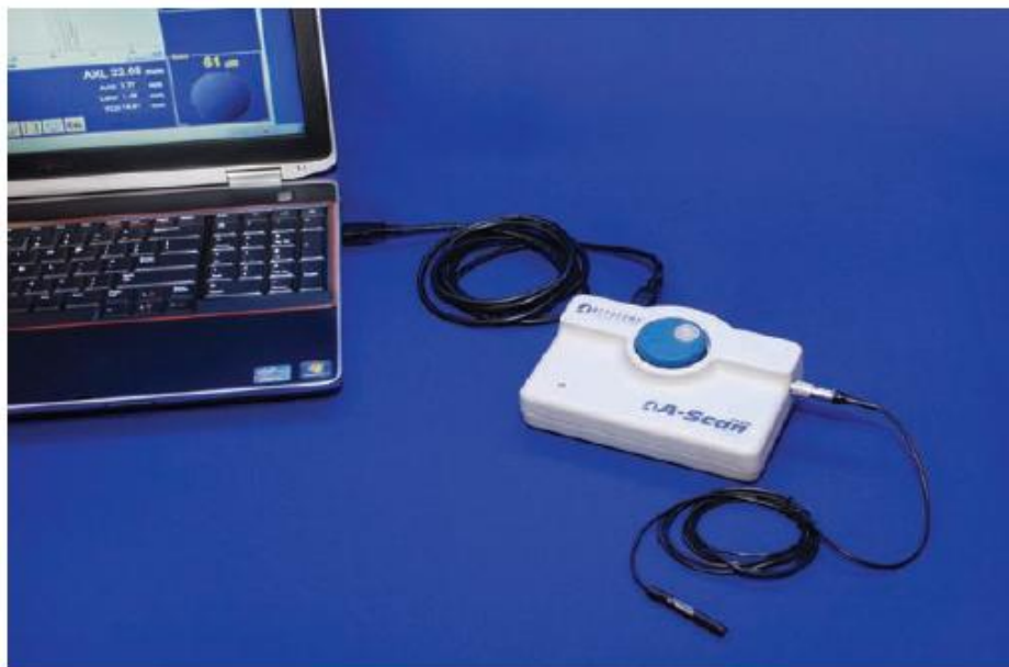
Рисунок 3-10 Блок управления A-Scan Plus, подключенный к портативному компьютеру при помощи USB кабеля
