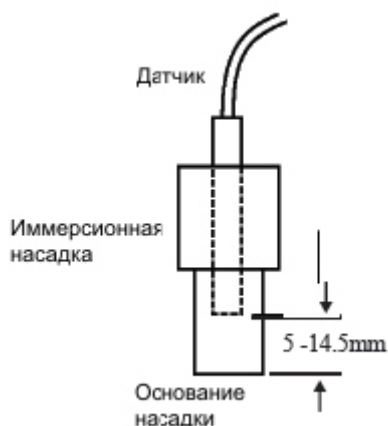
Рисунок 3-5 Датчик с иммерсионной насадкой
